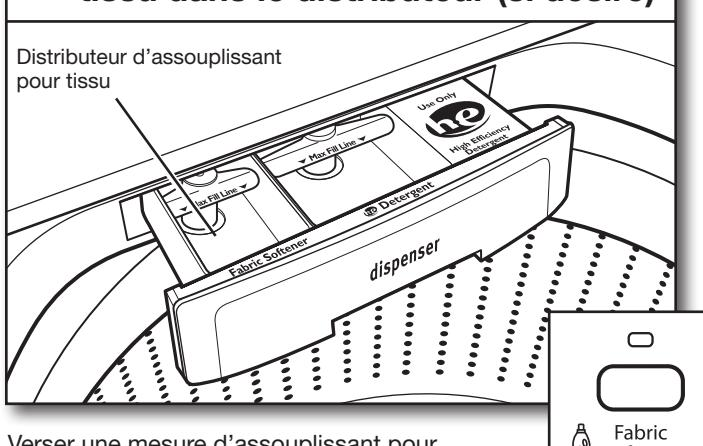
Verser une mesure d'assouplissant pour tissu liquide dans le distributeur – toujours suivre les instructions du fabricant concernant la dose d'assouplissant pour tissu à utiliser en fonction de la taille de la charge. Fermer le tiroir du distributeur, sélectionner ensuite l'option Fabric Softener (assouplissant pour tissu).
