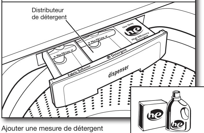
Ajouter une mesure de détergent HE dans le distributeur de détergent.
