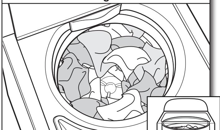
Pour un meilleur rendement, il est recommandé de déposer les vêtements en vrac et de façon uniforme le long du plateau de lavage. Essayer de mélanger différents types d'articles pour réduire l'emmêlement.
