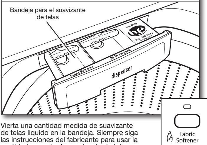
Vierta una cantidad medida de suavizante de telas líquido en la bandeja. Siempre siga las instrucciones del fabricante para usar la cantidad correcta de suavizante de telas según el tamaño de la carga. Cierre el cajón del depósito y seleccione la opción de Fabric Softener (Suavizante de telas).
