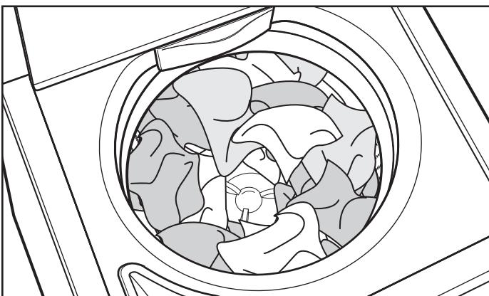
Pour un meilleur rendement, il est recommandé de déposer les vêtements en vrac et de façon uniforme le long du plateau de lavage.
