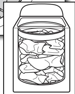
**IMPORTANT :** Les articles doivent pouvoir se déplacer librement pour un nettoyage optimal et pour réduire le froissement et l'emmêlement.
