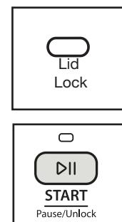
Si l'on doit ouvrir le couvercle, appuyer sur START/Pause/Unlock (Mise en marche/pause/déverrouillage). Le couvercle se déverrouille une fois que le mouvement du lave-linge a cessé. Il se peut que cela prenne plusieurs minutes si le lave-linge essorait la charge à grande vitesse. Appuyer de nouveau sur START/Pause/Unlock (Mise en marche/pause/déverrouillage) pour poursuivre le programme.
