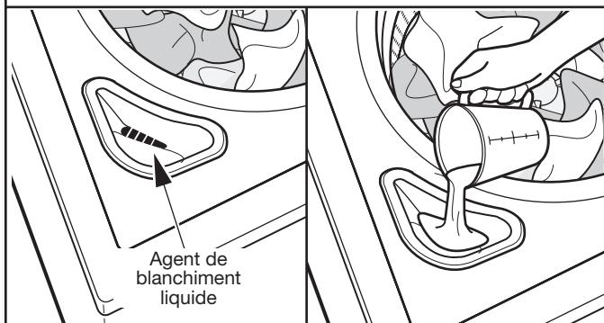
Ne pas remplir excessivement le distributeur ni utiliser plus de 236 mL (une tasse) d'agent de blanchiment liquide au chlore. Ne pas utiliser d'agent de blanchiment sans danger pour les couleurs ni de produit Oxi avec un programme utilisant de l'agent de blanchiment au chlore liquide.
