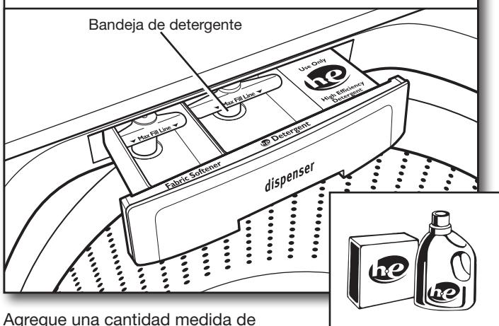
Agregue una cantidad medida de detergente HE en la bandeja de detergente. Esta bandeja tiene una capacidad para 89 ml (3 onzas). No llene en exceso la bandeja; el agregar demasiado detergente puede hacer que el mismo se distribuya demasiado pronto en la lavadora.
